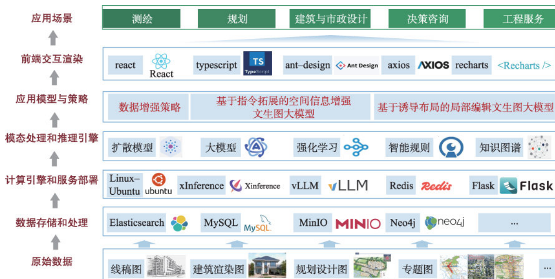
图6 面向城乡规划设计的文生图技术框架
